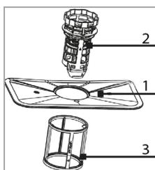
Das dreiteilige Filtersystem verhindert, dass größere Mengen an Speiseresten oder Fremdkörpern in das Spülsystem gelangen.
