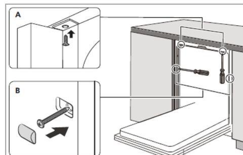
**A** Ist die Arbeitsplatte aus Holz, befestigen Sie das Gerät mit der Arbeitsplatte.
